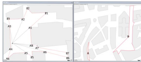
Figure 4. (gauche) Dans l'isovist associé au point de vue O, les points Ai matérialisent les huit occlusions associées à O et les points Bi les arrière plans correspondants. (droite) Deux situations extrêmes pour l'indicateur d'anticipation.
